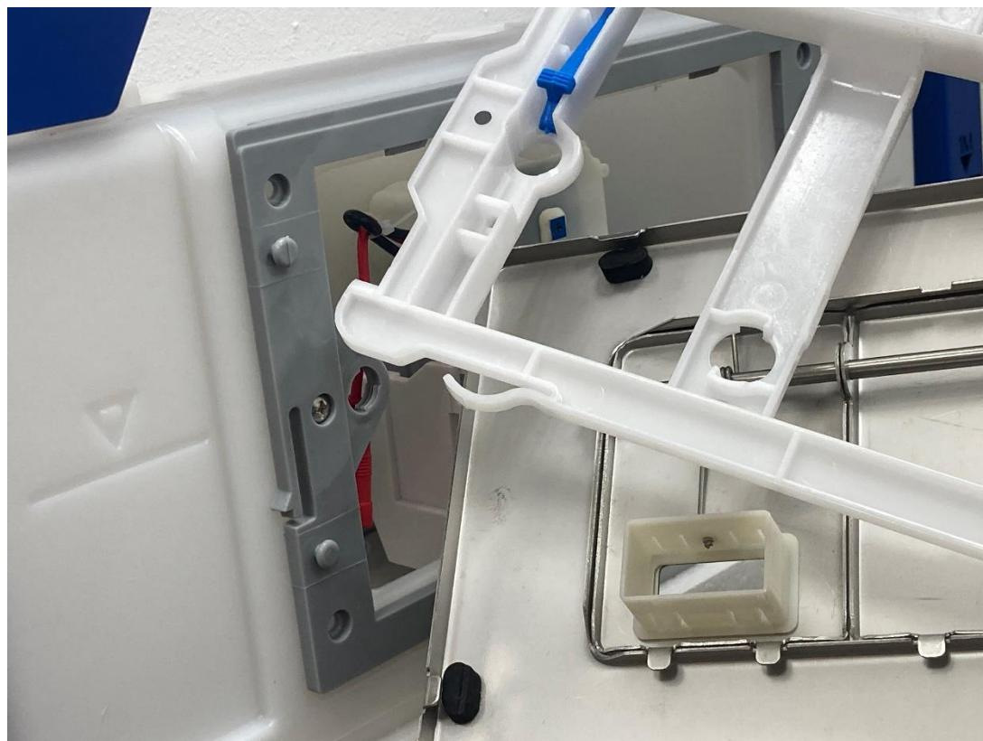
10.1 Используя специальные "Г" образные установочные болты, закрепите рамку на инсталляции (производится после окончательного монтажа инсталляции и завершения отделочных работ)
